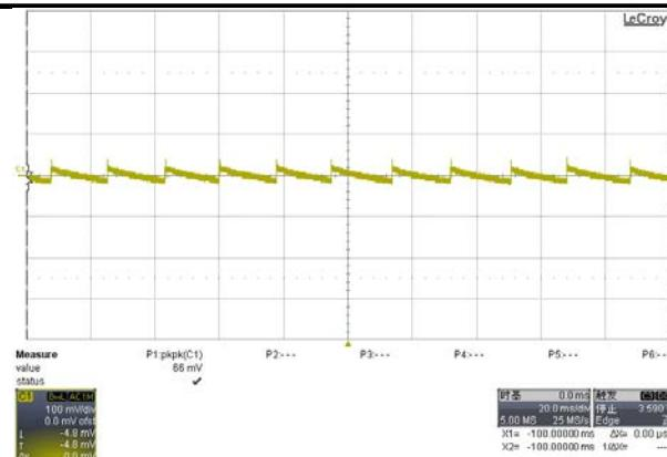
Fig. 4 R&amp;N waveform @264Vac; no load
