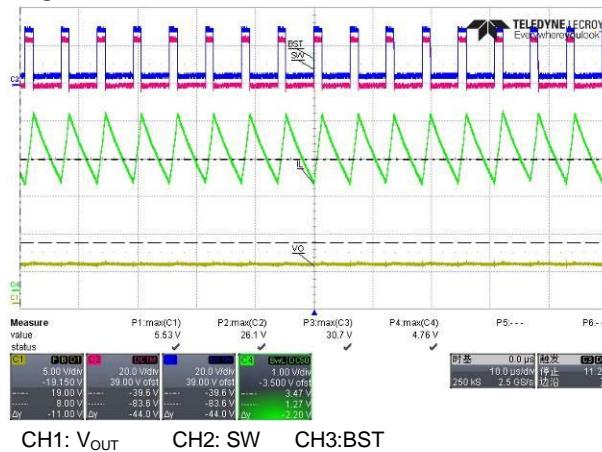
**Figure 33:** 5V/3.4A, V<sub>IN</sub>=24V, cc mode
