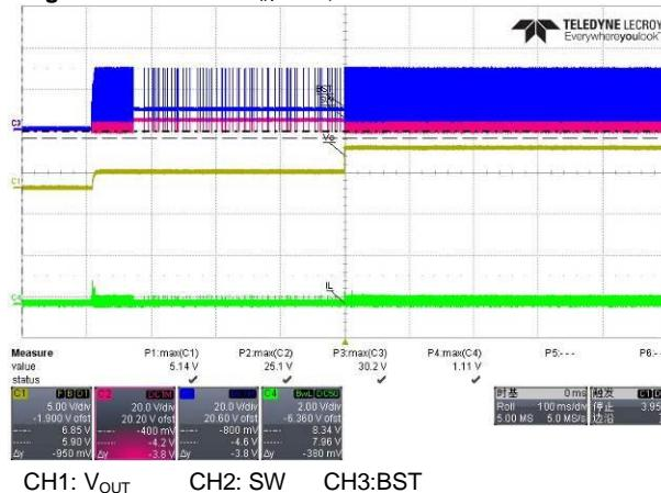
**Figure 31:** 5V/3.4A, V<sub>IN</sub>=24V, Normal,no load
