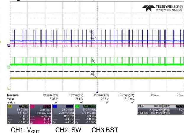
**Figure 32:** 5V/3.4A, V<sub>IN</sub>=24V,full load
