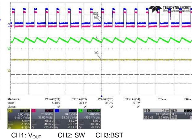
**Figure 34:** 5V/3.4A, V<sub>IN</sub>=24V,short
